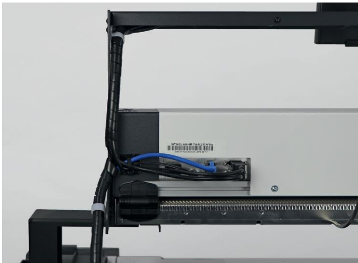
Pogled sa zadnje strane inteligentnog konektora i kablovskih vodiča
